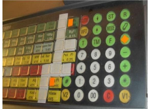
Bei der Bedienung der Kasse wurden nicht zu benutzende Tasten abgeklebt und benötigte Tasten visuell hervorgehoben. Diese Möglichkeit erleichtert die Orientierung und schafft somit eine erhöhte Arbeitsgeschwindigkeit.
